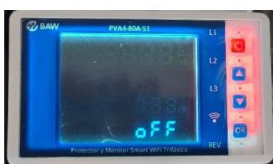
El protector indicará la desconexión "OFF" (apagado)
