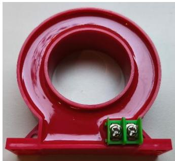
Previo al montaje se recomienda realizar el conexionado al transformador de corriente. El mismo posee dos terminales de conexión color verde con tornillo M3 x 8mm.
