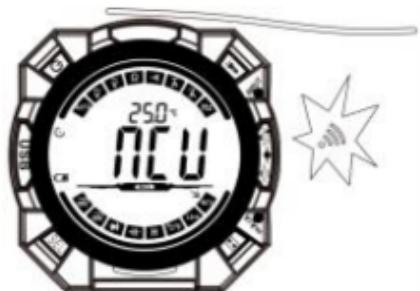
Incluso sin que se indique una alarma, puede haber tensión presente. No dependa únicamente de la función de detección de voltaje sin contacto (NCV) para determinar si existe tensión en el elemento energizado. La operación de detección puede verse afectada por factores como el diseño del tomacorriente, el grosor del aislamiento y el tipo de conductor. En el modo de detección NCV, el instrumento no medirá tensión, resistencia ni corriente.
