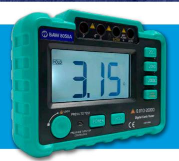
El **BAW8050A** es un instrumento destinado a la medición de resistencia de puesta a tierra (PAT), en diferentes tipos de entornos de prueba de resistencia:
